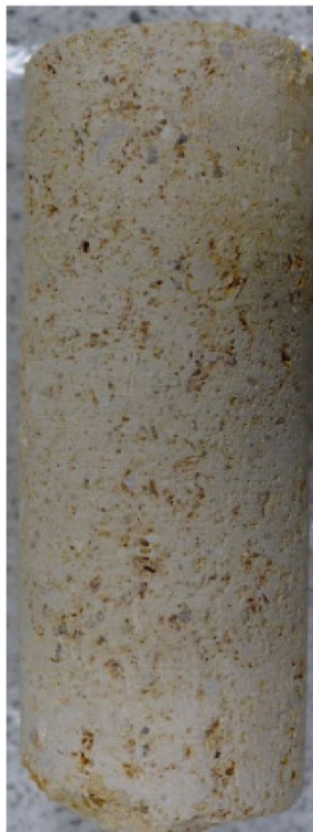
Bloc de St Emilion traité dans la masse par injection - Essai d'écrasement en Compression Simple
