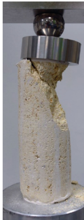
Bloc de St Emilion traité dans la masse par injection - Essai d'écrasement en Compression Simple
