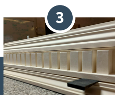
3 Assemblage des modules pour former la corniche.
