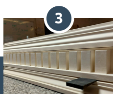
3 Assemblage des modules pour former la corniche.
